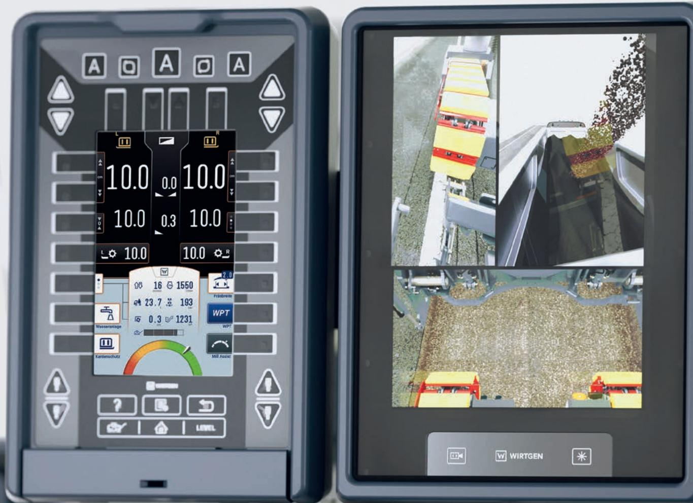
1 | Pannello di comando da 10" con schermo diviso per la visualizzazione simultanea delle immagini riprese da più telecamere.
