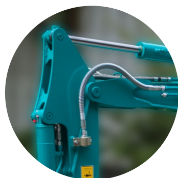
Protezione dei tubi in acciaio
