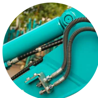
Tubazioni attacco rapido idraulico
